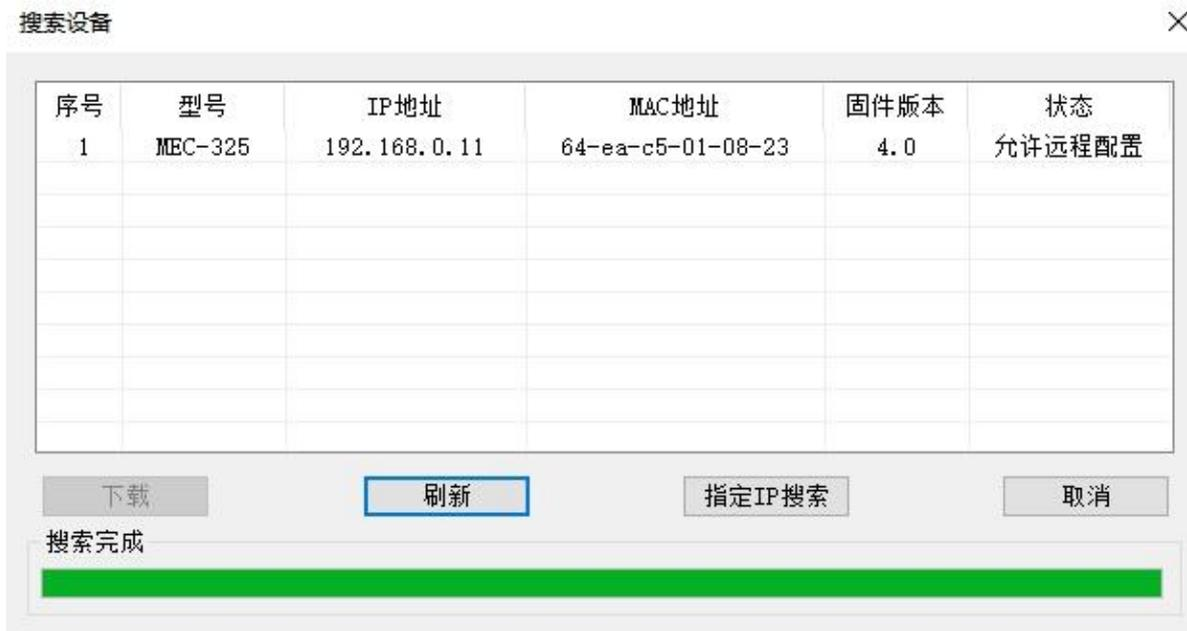
点击“下载”，窗口显示下载内容，一段时间后下载配置完成。
