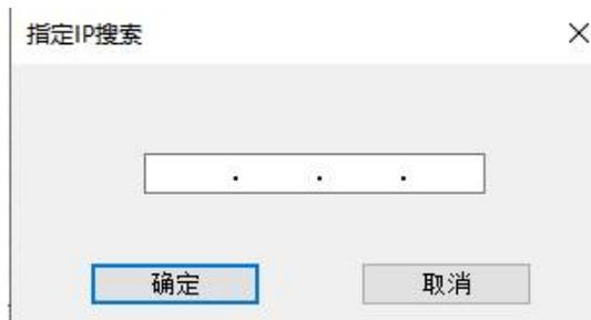
输入正确 IP 地址后，软件会搜索网络中具有这个 IP 地址的 MEC-325 设备。
